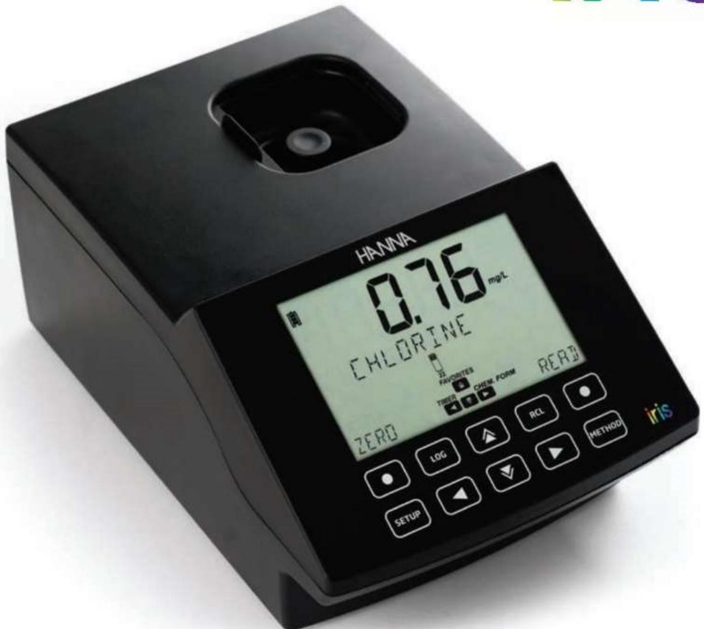
HI801 是 HANNA 基于其丰富先进的光学分析仪器研发与制造经验推出的一款多功能可见分光光度计，测量范围为 340-900 nm.采用先进的分束光学系统，内置 85 种测试方法的应用程序（可测量参数请参考后面参数表）和多达 100 种用户自定义方法，仪器软件可随时升级更新，可实现最多 150 种出厂测量方法程序的添加和更新。
